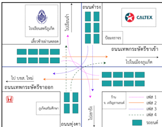
รูปที่ 4 การเปลี่ยนเฟสของสัญญาณไฟจราจร (เฟส คือ ด้านของการปลอ่ยยานพาหนะ)
